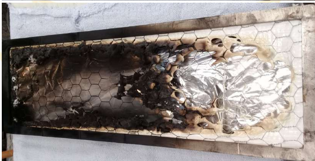
Ensaio de Determinação do Índice de Propagação (Painel Radiante) - Amostras antes e após o ensaio
