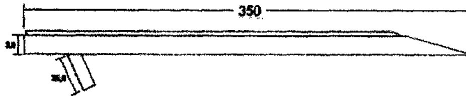
Figura 18 – Estaca cantoneira (medidas em mm)
