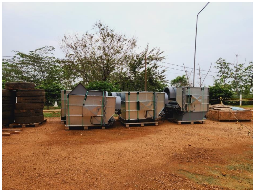
Equipamentos – Captação de Pó
