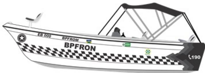
As embarcações deverão receber plotagem e/ou pinturas com tintas específicas e adequadas a adversidades expostas, e também levando em consideração o material a ser pintado, afim de evitar desgastes, bolhas e incrustamentos.
