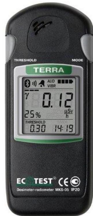
Utilizado para detectar ondas radioativas / nuclear.
