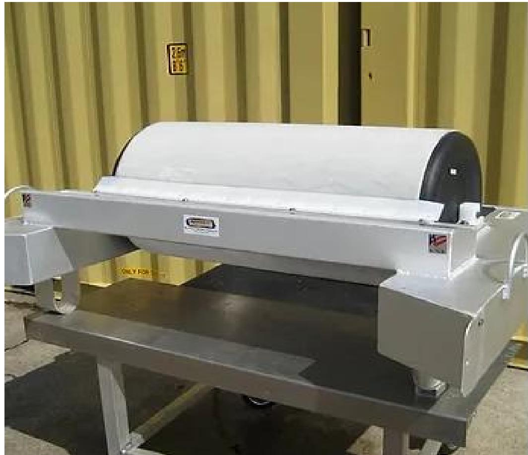
Ideal para recolher óleos de alta e média viscosidade. Possui uma bomba de deslocamento positivo é capaz de recolher de 30 a 60m<sup>3</sup>/h, capaz de ter um baixíssimo índice de recolhimento de água.
