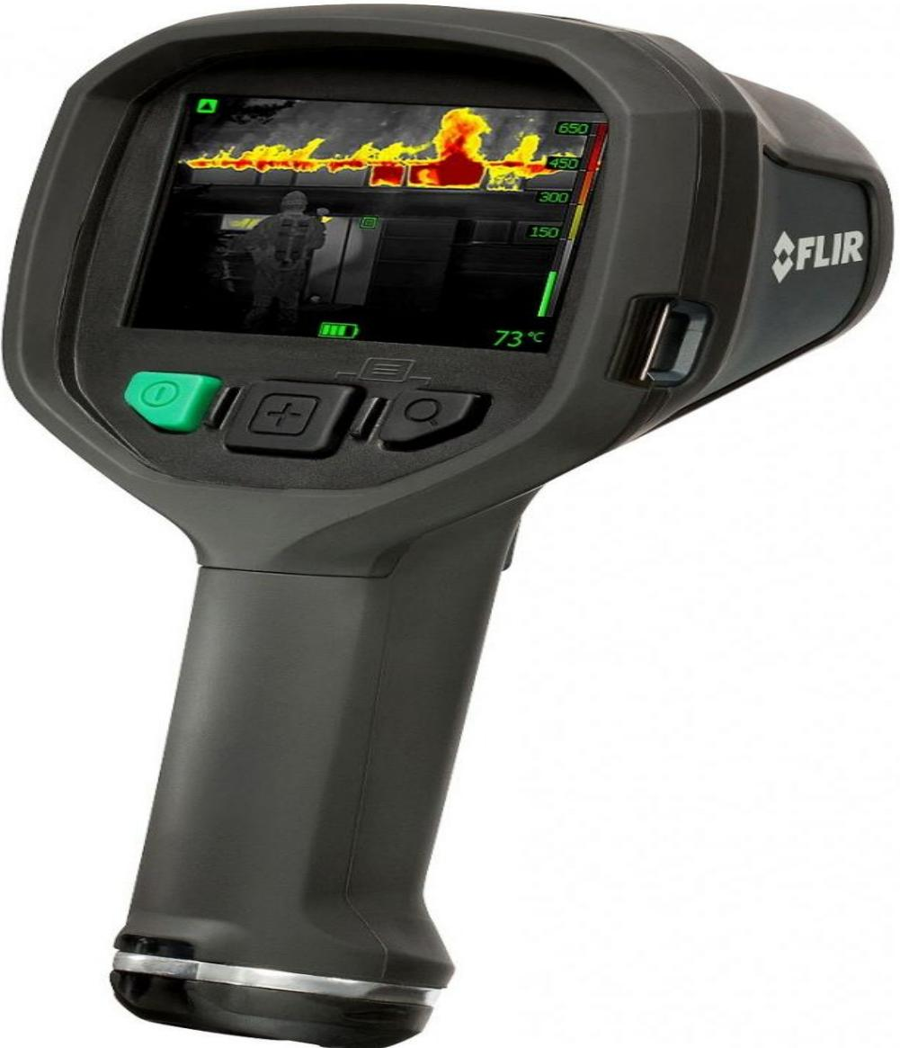
Câmera infravermelha robusta e confiável projetada para funcionar em condições extremamente severas. Certificada pela norma NFPA. Produz imagens com riqueza de detalhes em 320 x 240 pixels. As imagens térmicas são exibidas em um LCD amplo e nítido de pelo ao menos 4". Resistente a quedas e a água. Podendo operar em temperaturas elevadas (acima de 250° C). Possuir interface intuitiva e simples.
