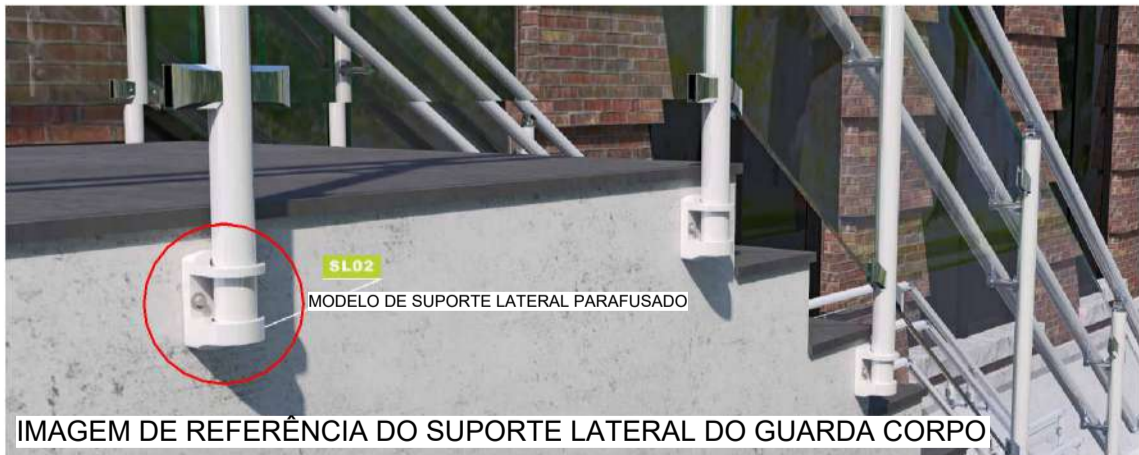
IMAGEM DE REFERÊNCIA DO SUPORTE LATERAL DO GUARDA CORPO
