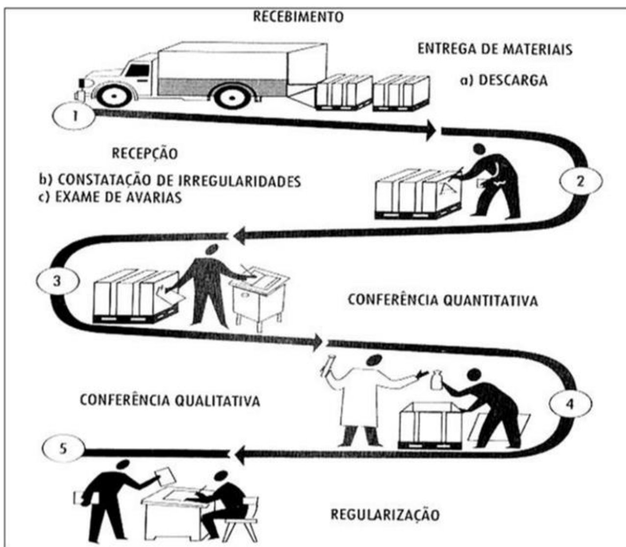
Figura 4: Procedimentos Técnicos para o Recebimento de Materiais | SEDUC-CAP Autor: Gleysson Francisco Shreder da Silva | Gerente de Apoio, Logística e Distribuição
