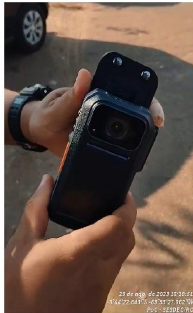
Suporte para capa de colete modular após queda da altura de 1.50 m de altura
