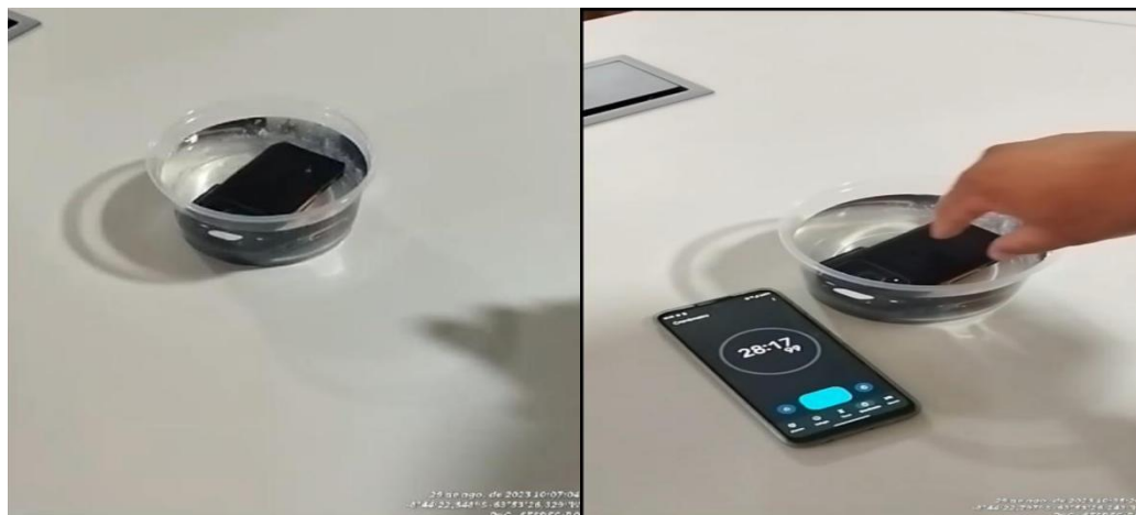
Figura 10 - Teste de imersão em andamento 10:07h às 10h: 36 m
