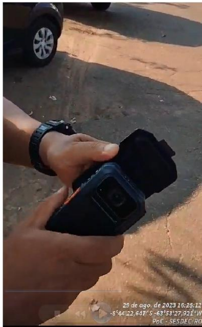
Suporte para capa de colete liso após queda da altura de 1.50 m de altura
