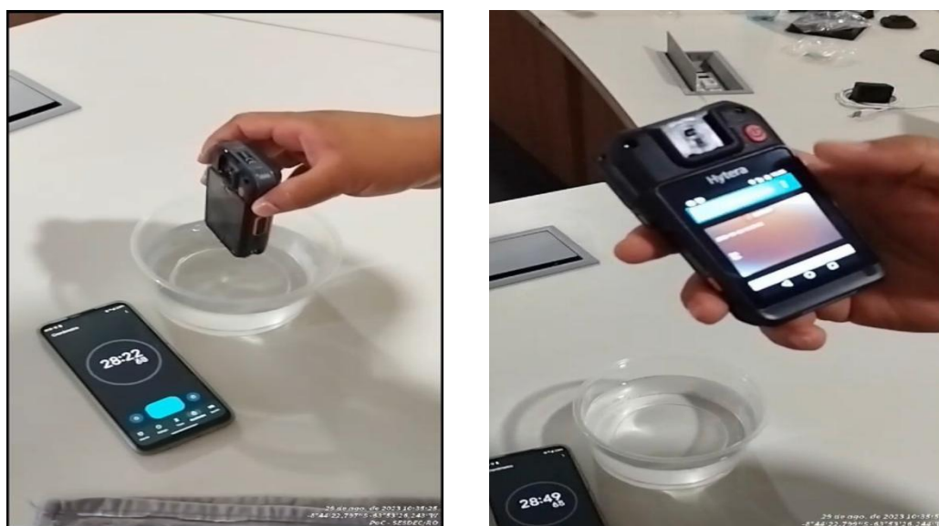
Figura 11 - Retirando o equipamento da água e testando
