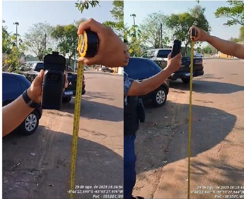
Teste de queda da altura de 1.50 m de altura
