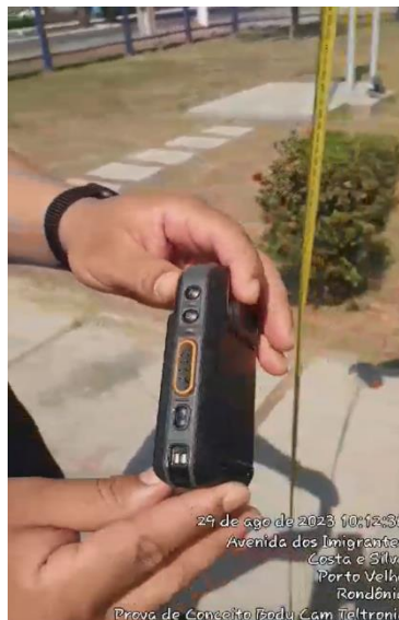
Figura 20 - Imagens do equipamento após queda
