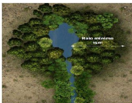
Figura 3 – Ilustração com o tamanho das faixas de APP a serem recuperadas em áreas suprimidas anterior a 22/07/2008, conforme determina a Lei Federal nº 12.651/2012 para APPs de nascentes.
