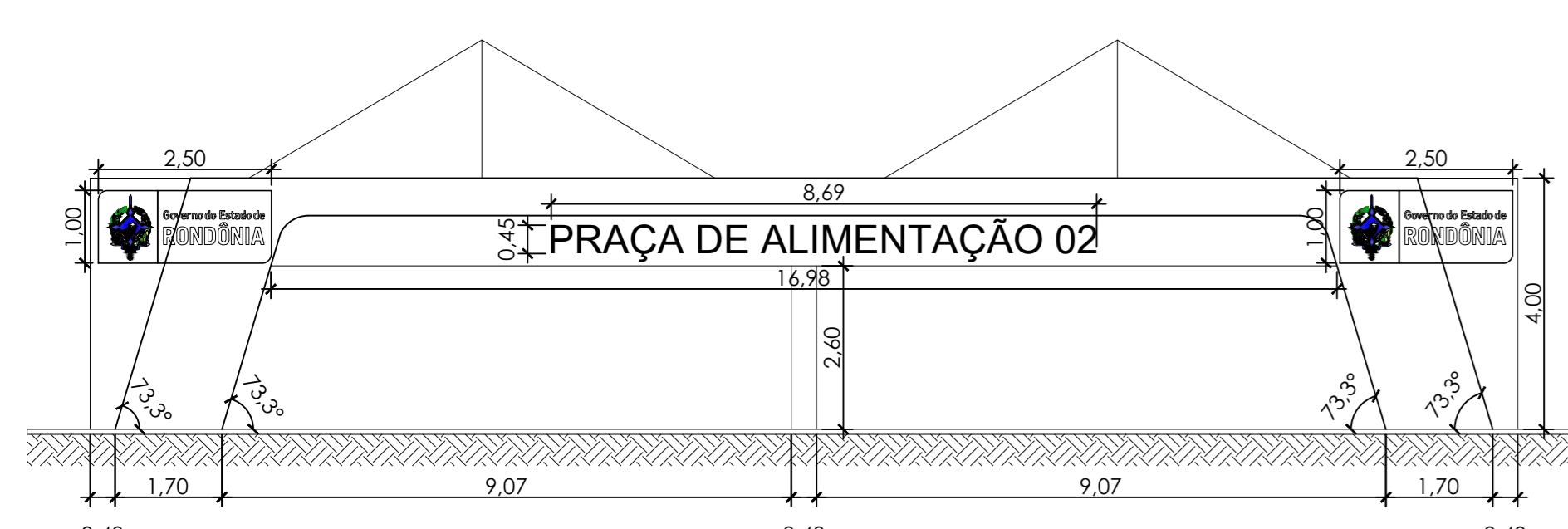
5 FACHADA LATERAL ESQUERDA ESC. 1:125
