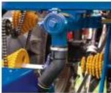
**Distribuição de adubo transversal:** através de Rosca Sem-Fim, com revestimento interno anti-aderente. O sistema transversal permite maior regularidade na distribuição de adubo em terrenos inclinados.
