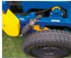
**Sistema de Rodado:** rodado totalmente independente, fixado na lateral do chassi com molas que permitem uma melhor flexibilidade para um acompanhamento das ondulações do terreno, evitando intermitência durante o plantio.
