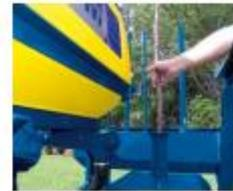
**Equipada com sistema de corte automático** das ramas, através de lâminas acionadas pelo pneu do equipamento. Tamanho aproximado do corte das manivas: 13,5 cm.
