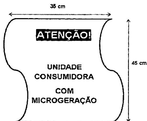
Figura 8 - Modelo de bandeirola para o ramal de ligação da unidade com microgeração
