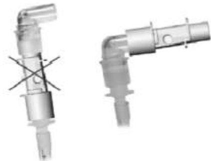
Figura 17: Posicionamento incorreto e correto do adaptador de vias aéreas
