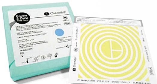
O teste Bowie & Dick foi desenvolvido para detecção da falha de funcionamento da bomba de vácuo e penetração de vapor dos esterilizadores com bomba vácuo.
