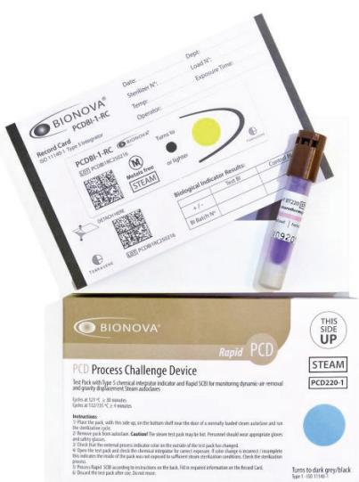
O Pacote Teste Desafio de uso único foi desenvolvido com a finalidade de desafiar os processos de esterilização a vapor de equipamentos gravitacionais e com bomba de vácuo, segundo recomendações da AAMI (Association for the Advancement of Medical Instrumentation). O teste é composto por uma série de barreiras permeáveis ao vapor entre as quais encontra-se um indicador biológico e um integrador químico tipo 5.
