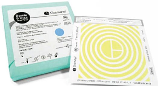
O teste deve ser realizado com a câmara aquecida, no primeiro ciclo do dia e com a câmara vazia.
