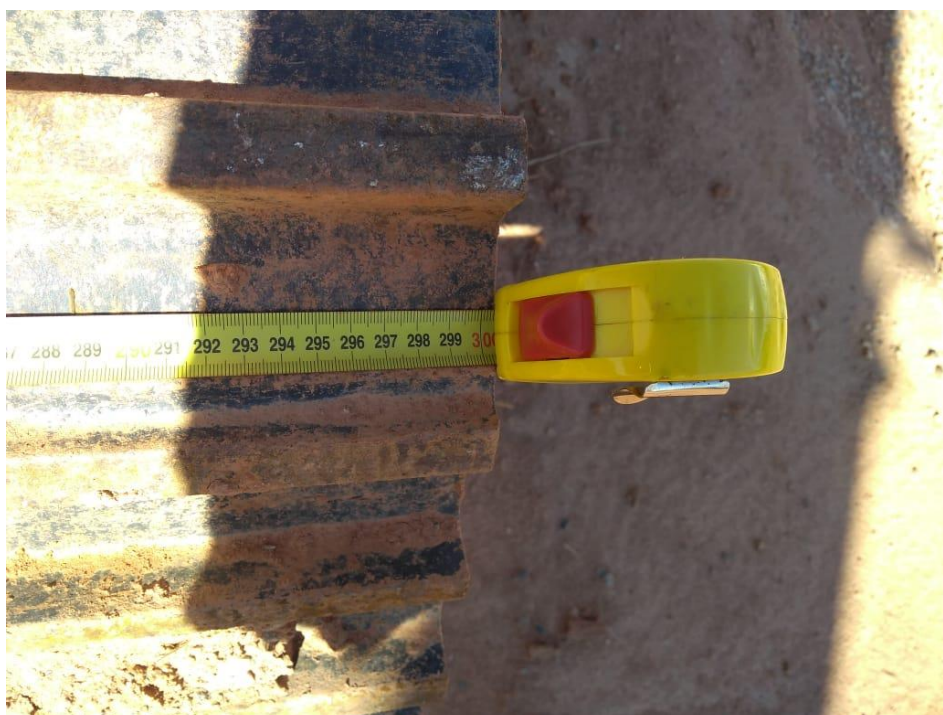
(IMAGEM 04 – AMPLIAÇÃO: MEDIÇÃO DA LARGURA 3.000 MM.)
