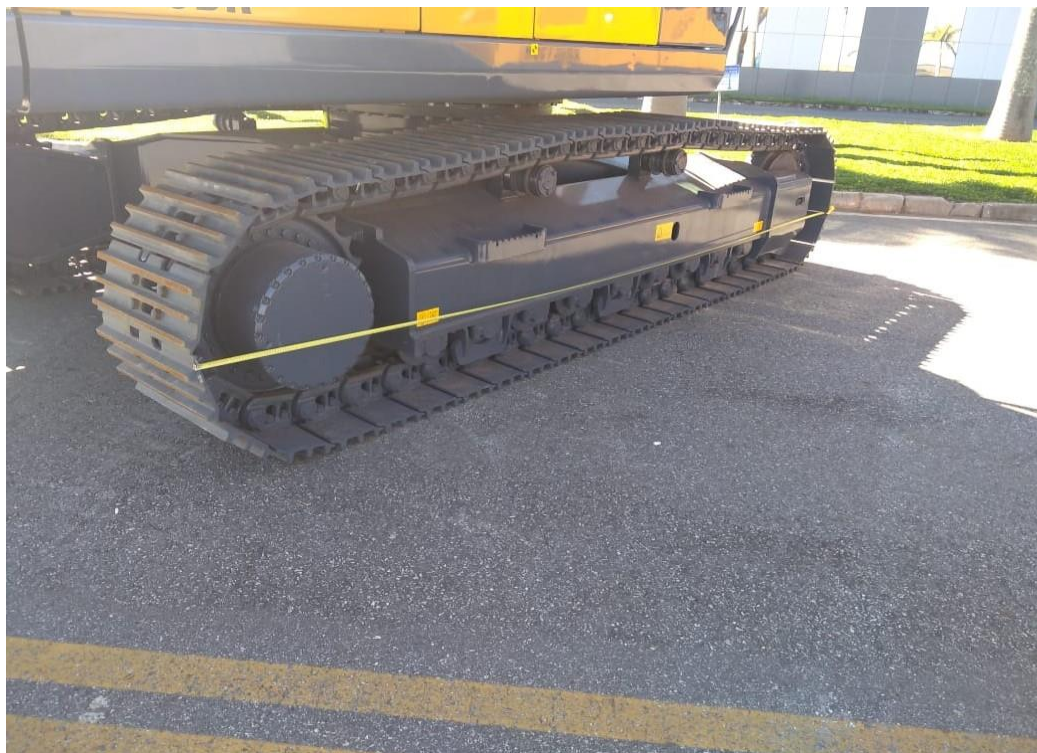
(IMAGEM 05 – MEDIÇÃO DO COMPRIMENTO 4.400 MM.)
