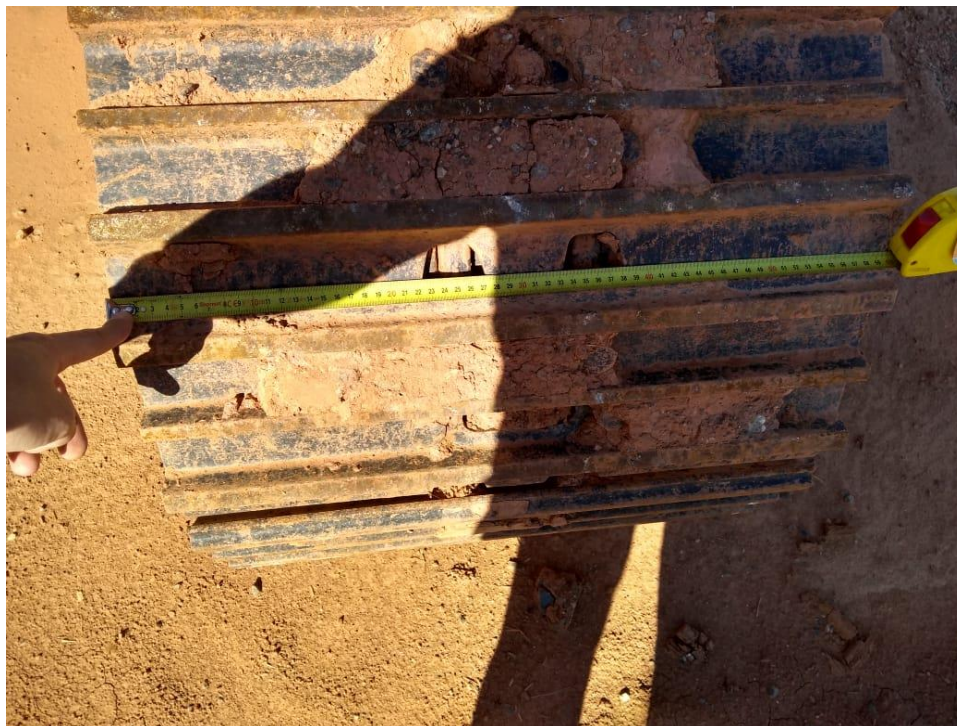
(IMAGEM 01 – MEDIÇÃO DA SAPATA 600 MM.)
