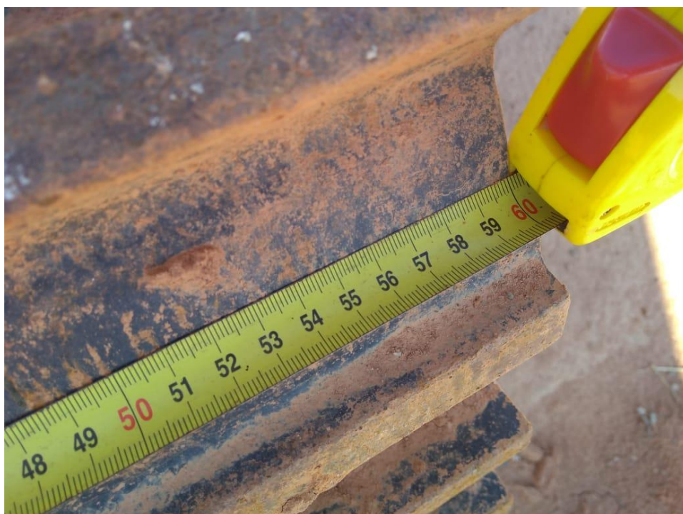
(IMAGEM 02 – AMPLIAÇÃO: MEDIÇÃO DA SAPATA 600 MM.)
