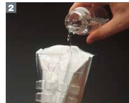
2 Despeje no Quanti-Tray* (contagens de 1 a 200 NMP/100 mL) ou Quanti-Tray*/2000 (contagens de 1 a 2.419 NMP/100 mL).
