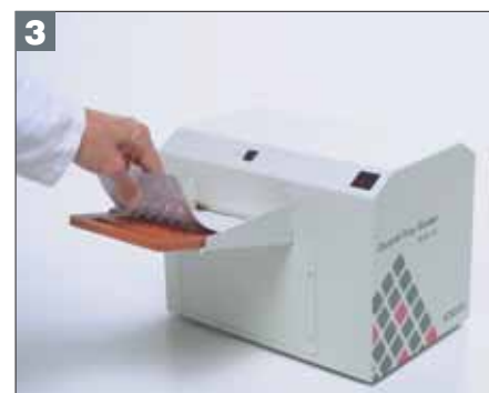
3 Vede com o selador Quanti-Tray Sealer e coloque na incubadora por 24 horas a 35 °C.
