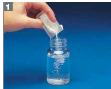
1 Adicione reagente à amostra e misture bem.
