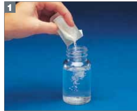
1 Adicione o reagente à amostra e incube por 24 horas a 35 °C.
