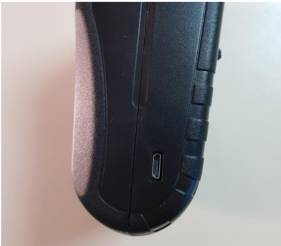
Em análise da capa de proteção e transporte da referida impressora, restou identificado que os mesmos orifícios acima identificado não são protegidos por esta capa, portanto entendemos que a capa não garante o GRAU DE PROTEÇÃO IP54 (proteção contra poeira e água), conforme identificado imagem abaixo:
